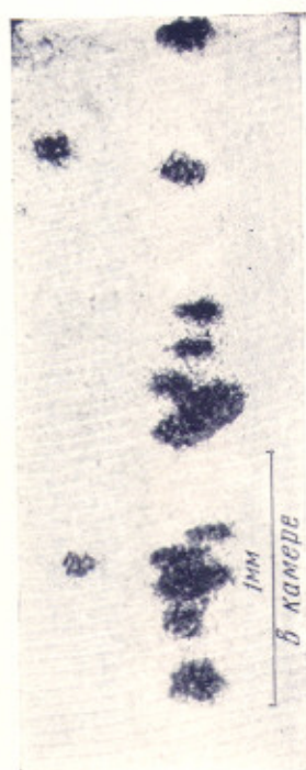
Рис. 7. Микрофотография следа быстрой космической частицы в диффузионной камере при большом увеличении
